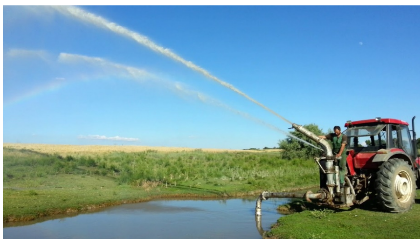
Рис 2.19 Дальнеструйные дождевальные машины ДДН-70
