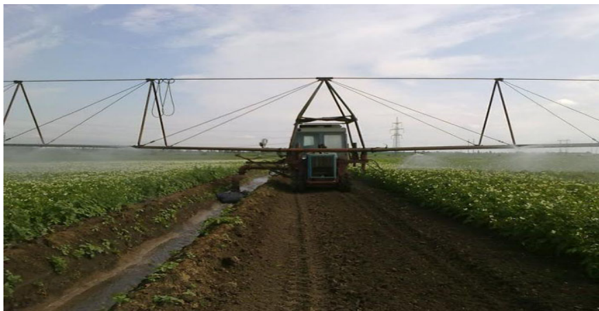
Рис 2.18 Дождевальная машина консольного типа ДДА-100МА
