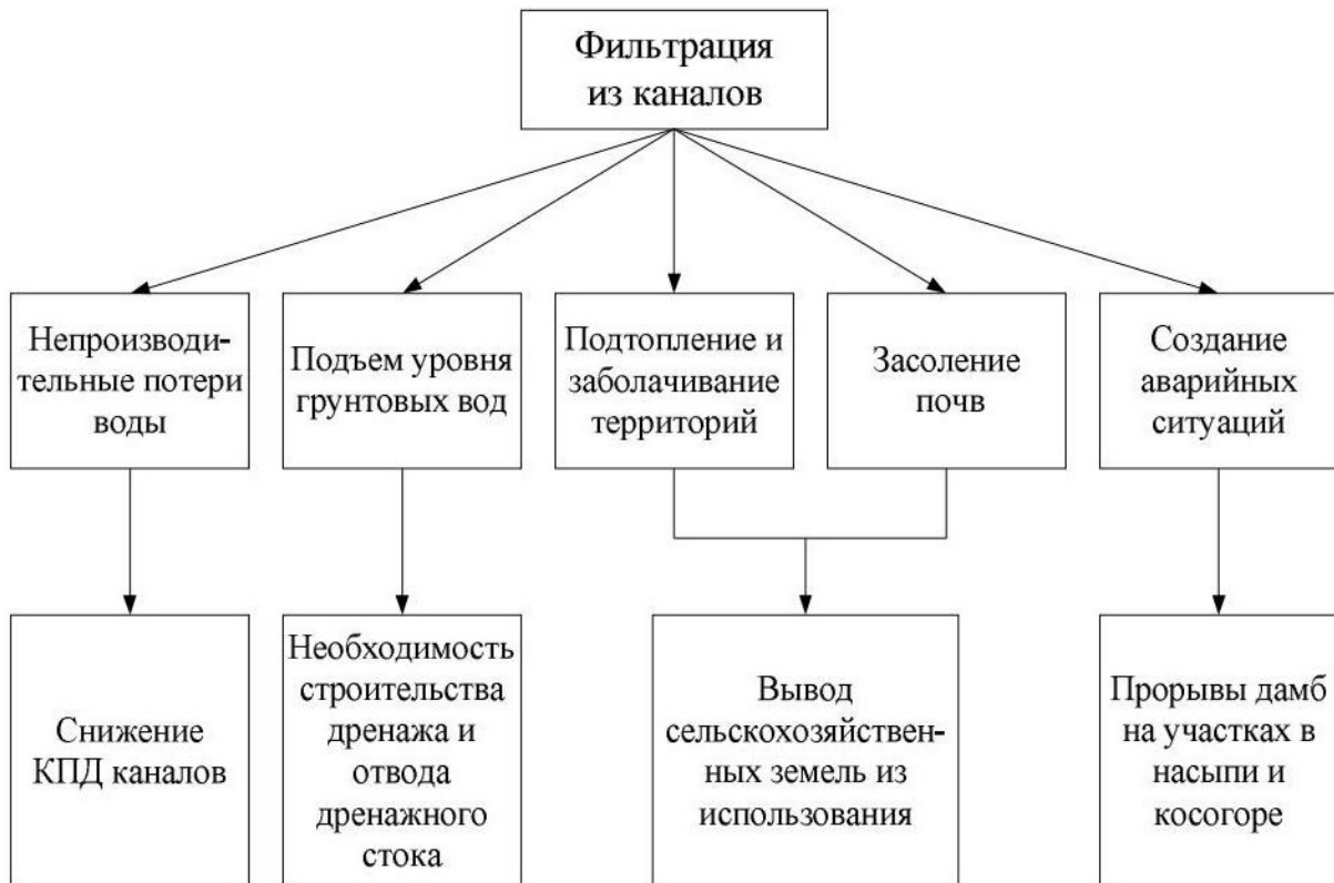
Рис. 4.2. Последствия фильтрации из оросительных каналов
