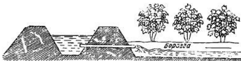
Рис. 2.6 Подача воды в борозды трубочками
