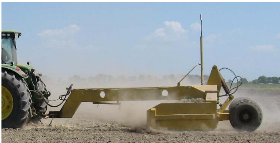
Рис. 3.2 Короткобазовый планировщик ПАУ-4,2 с лазерным управлением
