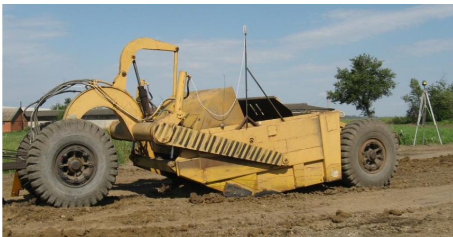
Рис. 3.1 Прицепной скрепер ДЗ-77 с лазерным управлением
