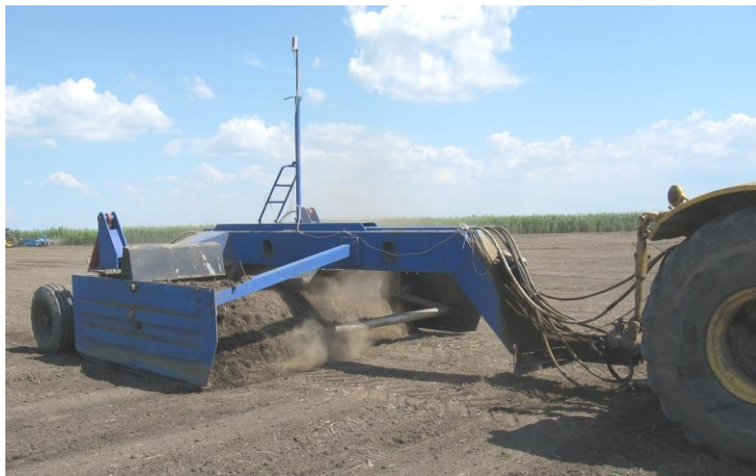
Рис. 3.4 Короткобазовый скрепер-планировщик СП-4,2 с лазерным управлением
