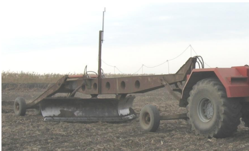
Рис. 3.3 Прицепной клин-планировщик КП-719 с лазерным управлением
